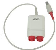
Este módulo mide la presión arterial directa (SYS, DIA y MAP) de un vaso sanguíneo seleccionado a través de dos canales, y muestra dos formas de onda de presión arterial mide la presión arterial directa (SYS, DIA y MAP). Las etiquetas de presión disponibles son:
